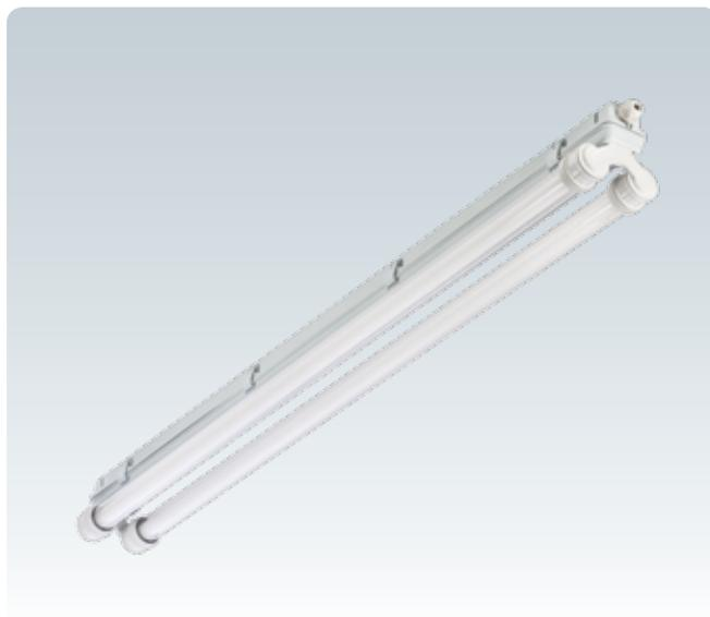
Имеется возможность реализовать функцию плавного нарастания освещенности при включении и плавного уменьшения освещенности при отключении светильников. Для этого светильники комплектуются регулируемыми ЭПРА (RA – аналоговое управление, RD – цифровое управление по протоколу DALI). Это позволяет также применять данные световые приборы для освещения объектов птицеводства, так как они соответствуют определенным зоотехническим требованиям.
