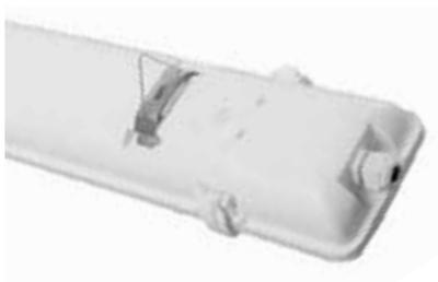
В корпусах светильников из поликарбоната (PC) не допускается высверливать или выдалбливать отверстия для крепления на несущую поверхность. Крепление производится защелкиванием корпуса в пластину (арт. 01846), которая крепится на несущую поверхность. Для подвеса светильников используется элемент подвеса (арт. 01853), который защелкивается в пластину (арт. 01846). Пластина (арт. 01846) и подвес (арт. 01853) входят в комплект поставки светильника из поликарбоната (PC).
