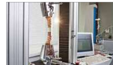
Испытания наконечников на разрывное усилие
