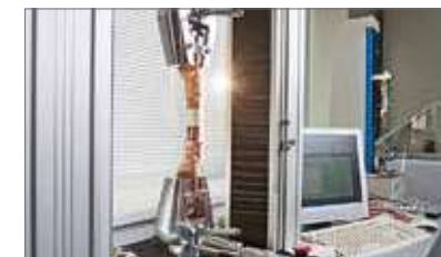
Испытания наконечников на разрывное усилие
