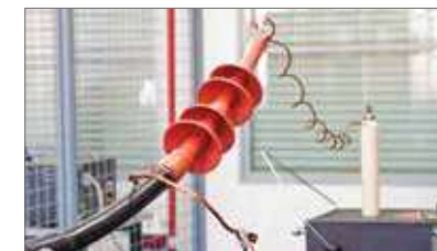
Высоковольтные испытания кабельных муфт
